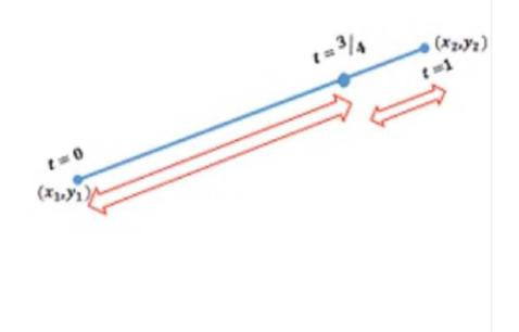
At time t  $x=(1-t).x_1+t.x_2$  $y=(1-t).y_1+t.y_2$  $x = x_1 - x_1 \cdot t + t \cdot x_2$  $=x_1 + t(x_2 - x_1)$  $x = x_1 + t\Delta x$  $y=y_1 - y_1 \cdot t + t \cdot y_2$  $=y_1 + t(y_2 - y_1)$  $y = y_1 + t\Delta y$
